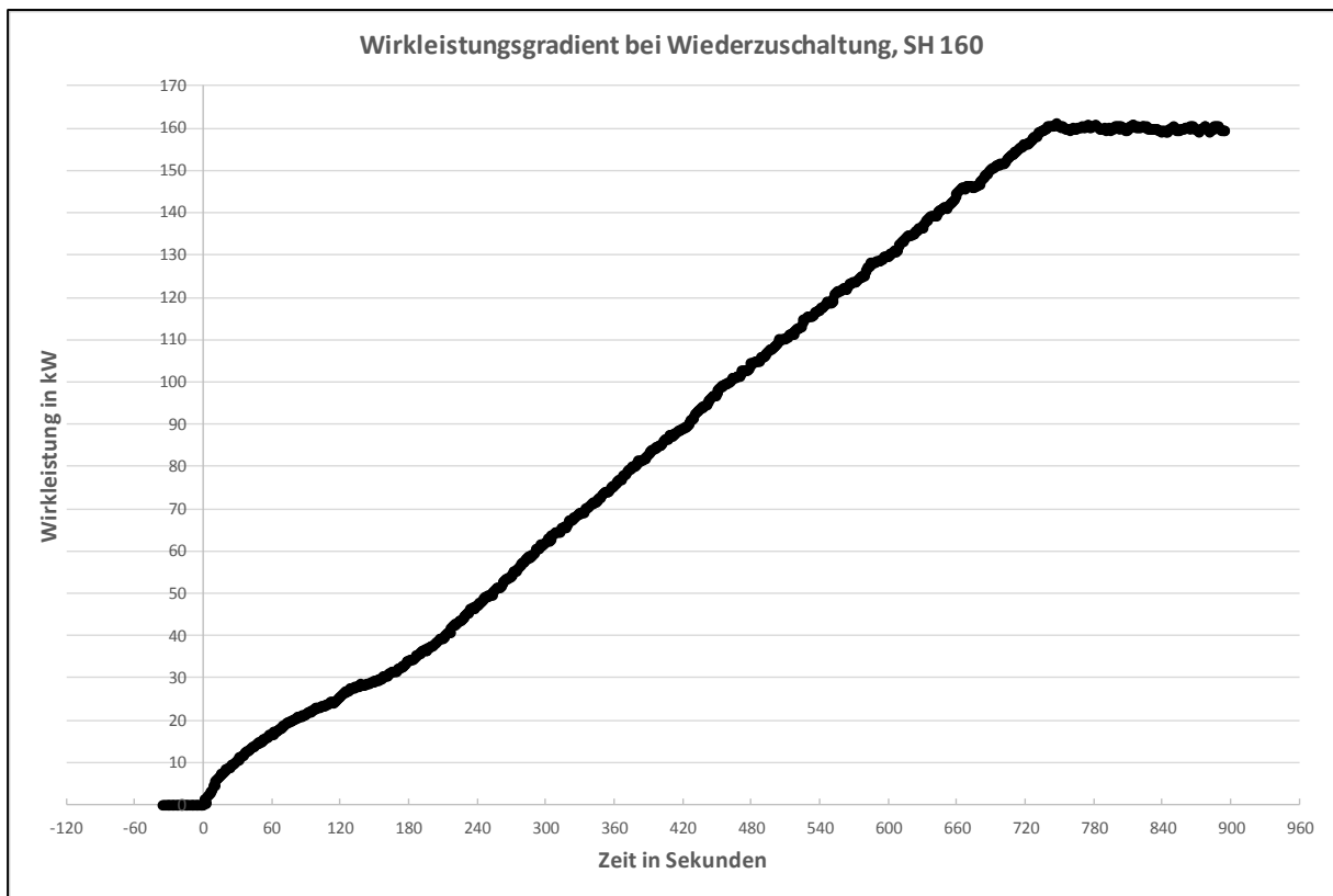
Abbildung 10: SH 160 160 kW: Wirkleistung nach Wiedereinschaltung
